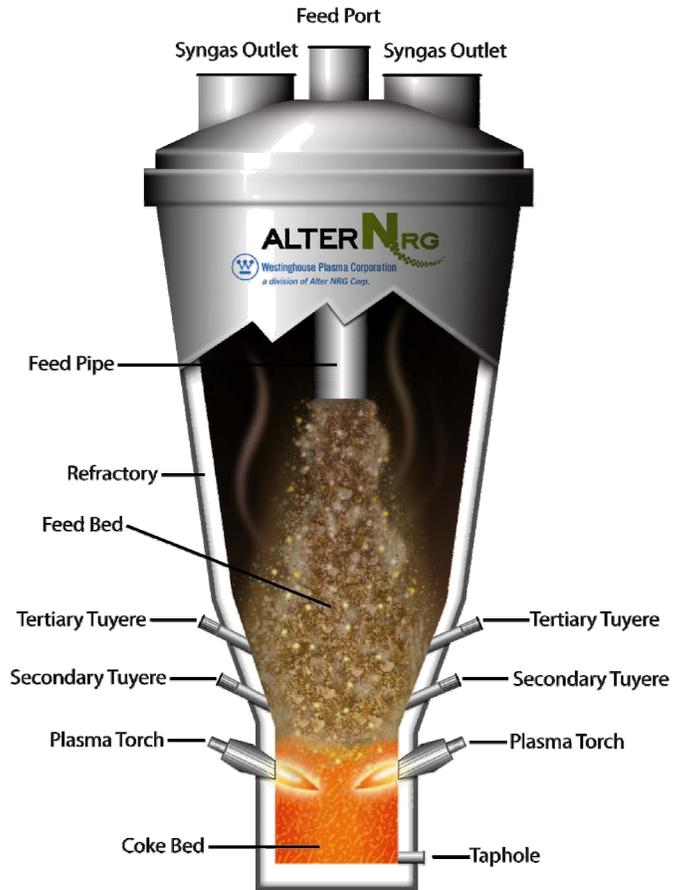
FIGURE 6 - ALTER NRG GASIFICATION REACTOR
