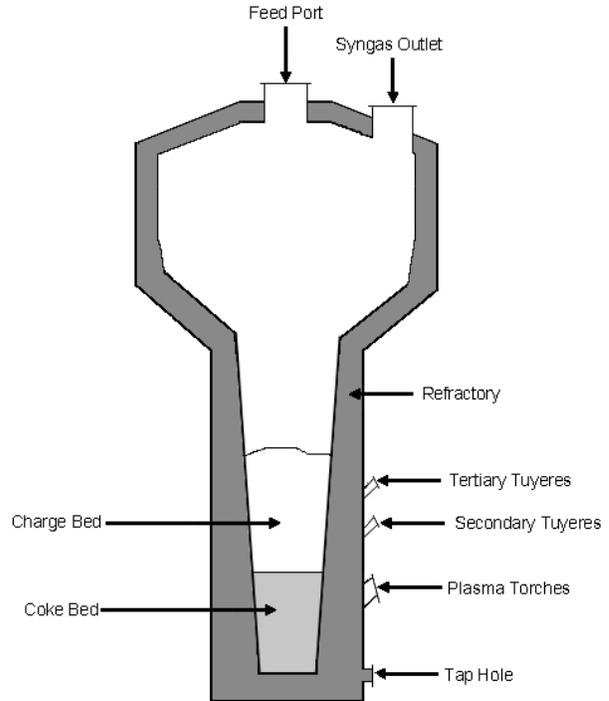
**FIGURE 4 - SCHEMATIC OF ECOVALLEY PLASMA GASIFICATION REACTOR**
